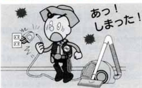
コンセントからプラグを抜くときにコードを引っ張って抜くと、接続部に力がかかり電線が切れて思わぬ事故のもとになります。プラグを抜くときは必ずプラグを持って抜く習慣をつけましょう。
